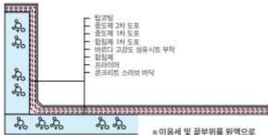
바르다 고강도 섬유시트 방수 공법(바닥 및 파라펫)
